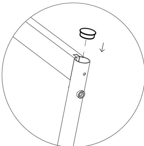
**Serrez les boulons aux quatre coins et insérez quatre capuchons dans la partie supérieure des tubes de connexion**
