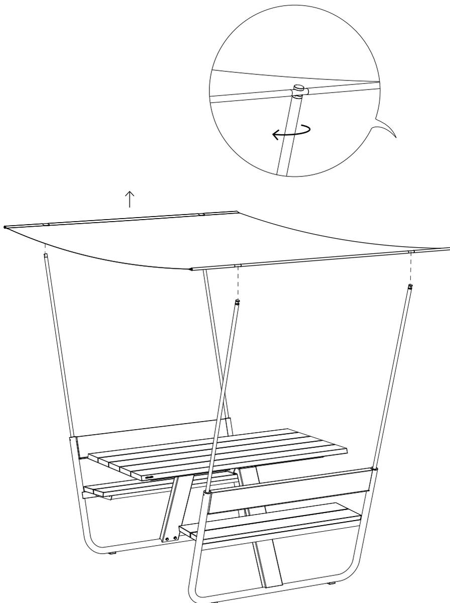
**Drehen Sie die vier Rohre jedes Mal um 90°, um das Schirmdach zu lösen und zu entfernen.**
