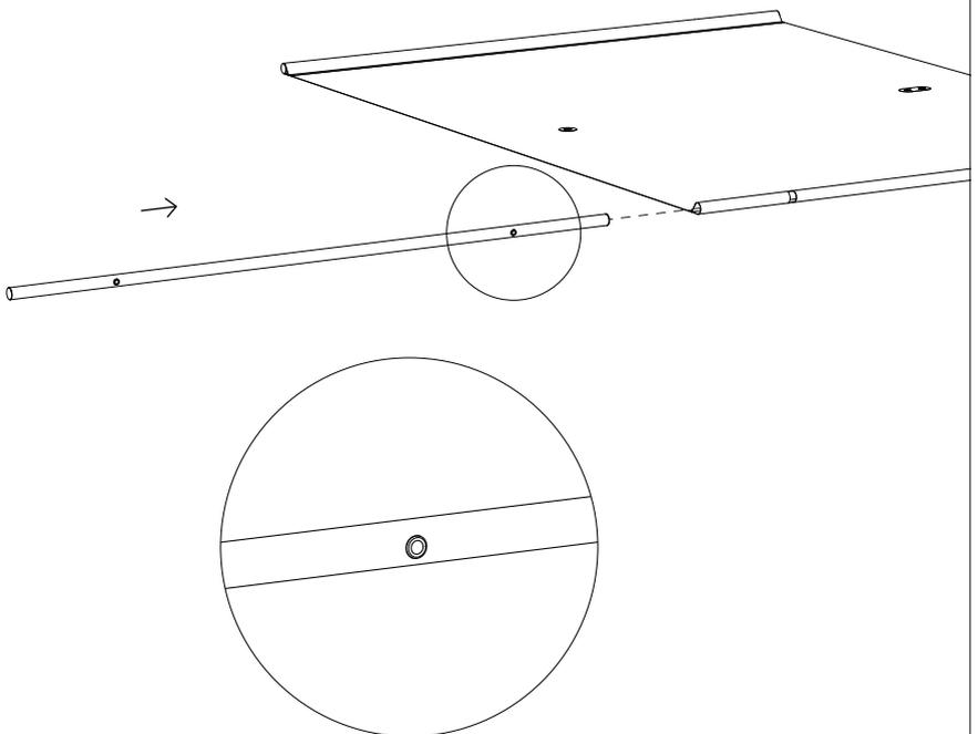
**Achten Sie darauf, dass die Löcher in den Rohren nach außen zeigen**
