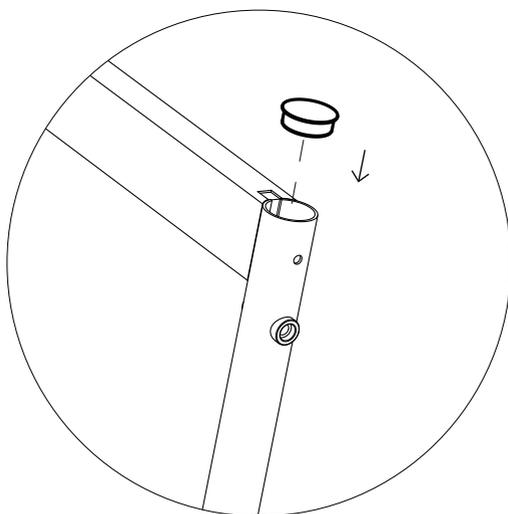
**Ziehen Sie die Schrauben an allen vier Ecken an und setzen Sie vier Kappen in die Oberseite der Verbindungsrohre ein**
