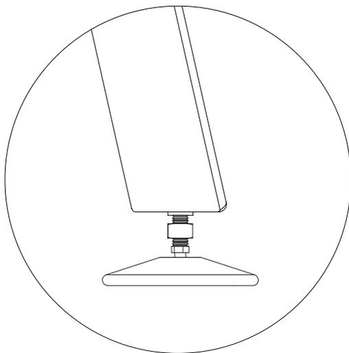
**Mettez la table à niveau en ajustant les cales de mise à niveau**
