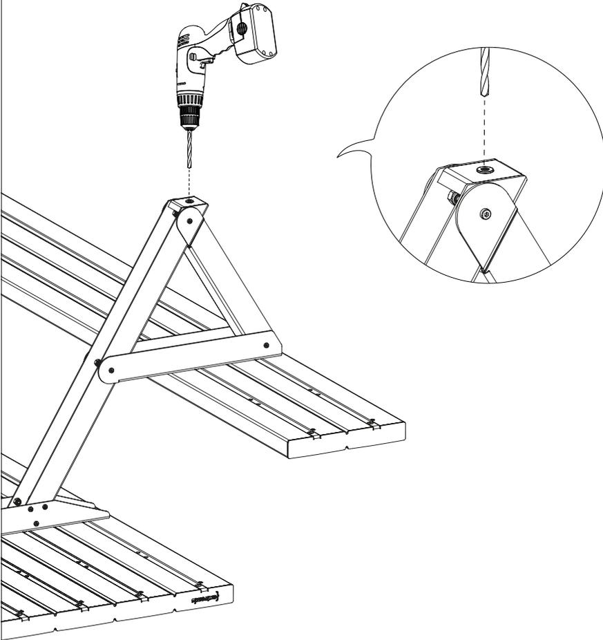
Falls die Bodenverankerung nachbestellt wurde, ist die Wahrscheinlichkeit hoch, dass die Zugmuttern sich noch in den Tischbeinen befinden. **Bohren Sie die Zugmuttern mit einem Bohrer  $\varnothing 12$  aus**
