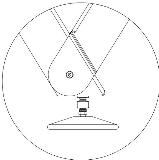
**Nivellieren Sie den Tisch, indem Sie die Nivellierfüße mehr oder weniger stark drehen**
