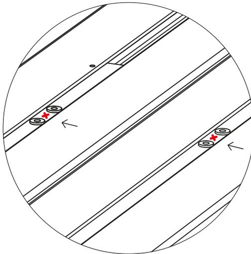
**Achten Sie darauf dass die Kreuze an der Unterseite der Profile zur gleichen Seite zeigen**
