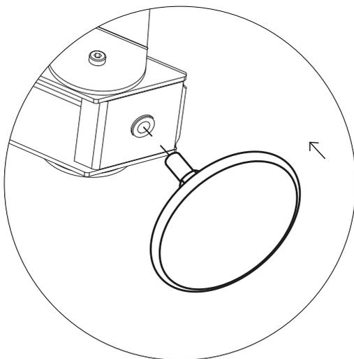
**Wiederholen Sie die Schritte 6a-6c für jedes Beinpaar und legen Sie sie beiseite**
