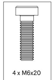
Positionieren Sie zuerst die Schrauben an der Innenseite des Tisches, dann die Schrauben an der Außenseite - **Ziehen Sie all Schrauben fest!**
