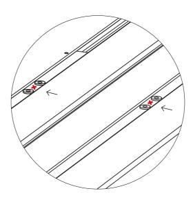
Bei mehr als 2 Beinen darauf achten, dass die Kreuze an der Unterseite der Profile zur gleichen Seite zeigen
