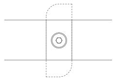
Befestigen Sie beide Ankerplatten im Tischplattenprofil, indem Sie es um 90° drehen Ziehen Sie die Schraube fest!
