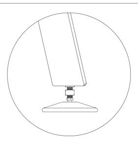
Nivellieren Sie den Tisch, indem Sie die Nivellierfüße mehr oder weniger stark drehen
