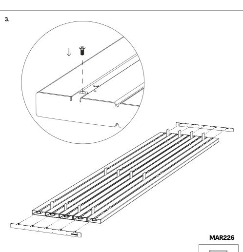
Führen Sie dies auf beiden Seiten durch - Ziehen Sie all Schrauben fest!
