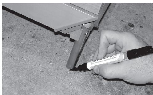
5. Indique donde las barras tocan el suelo. Desplace la banca o la mesa al terminarlo. Sujete las patas según las instrucciones en el manual Extempore.
