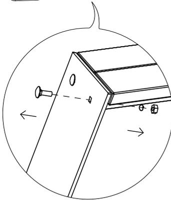
**Entfernen Sie diese Schrauben, Muttern und Federringe an der Außenseite der Sitzbank**
