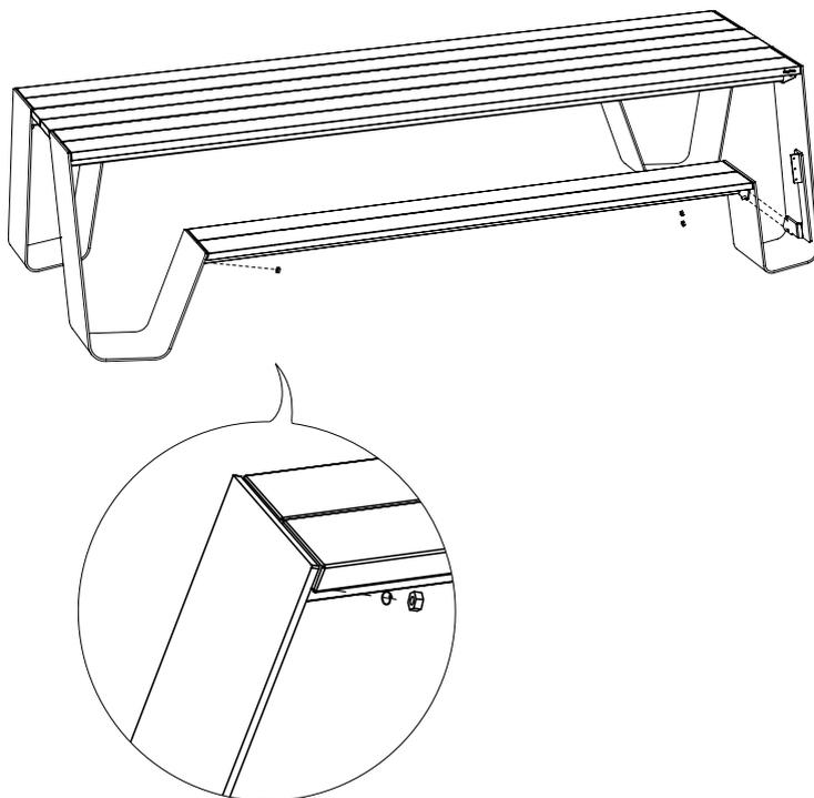
**Entfernen Sie diese Schrauben, Muttern und Federringe an der Außenseite der Sitzbank**
