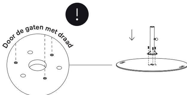
1. Plaats de gegalvaniseerde grondplaat op de grond en monteer de roestvrij stalen buis erop met 3 bouten M6x12. Let op: Zorg ervoor dat je de bouten in de schroefdraad van de grondplaat bevestigt zoals op de tekening!
